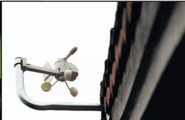
Vindmåleren på taget.
