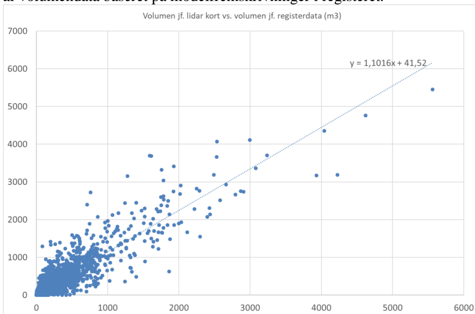
Figur 3 - Volumen fra Lidar vs. Total volumen fra registerdata
