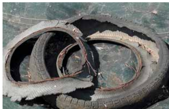
Figur 4. Mørnede bildæk med blottet kantråd. Kanttrådene er rustne og knækket i mindre stykker.
